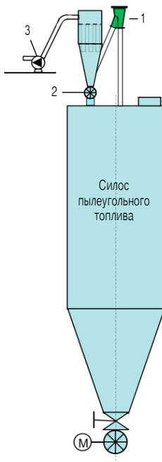
Рис. 1. Схема силоса пылеугольного топлива с отдельно расположенным фильтром
